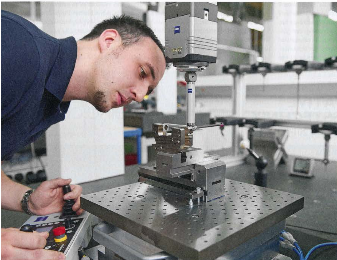
Bild 1: Portalmessgerät mit Scanningmesskopf, in den eine Drehachse integriert ist. So kann das Tastersystem in Abständen von 15° beliebig weit gedreht und so immer im richtigen Winkel zum Bauteil positioniert werden.
